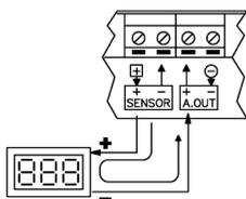
**Salida 4-20mA ACTIVA**. El equipo suministra la alimentación al bucle de corriente. El equipo al que lo conectamos es pasivo y únicamente está intercalado en el bucle.
