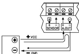
**Salida 4-20mA PASIVA**, alimentado con una fuente exterior. El equipo externo es el que suministra la alimentación al bucle de corriente, nuestro equipo se comporta como un sensor 4-20mA pasivo.
