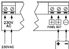
**Corriente alterna y batería recargable.** Cuando usamos la alimentación a 230V podemos conectar una batería entre los terminales "+BAT" y "-". La batería se carga mientras hay alimentación de 230V. Cuando se pierda la alimentación de 230V, la batería será la que alimente al equipo.
