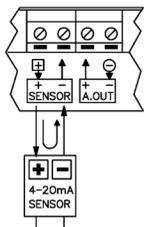
**Sensor 4-20mA PASIVO**, alimentado por el propio equipo. Esta es la conexión típica, donde el equipo alimenta al sensor directamente. En el modo LOW POWER sólo alimenta el sensor unos instantes mientras realiza la medida.
