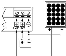
**Panel solar y batería recargable.** El equipo se puede alimentar con un panel solar externo conectado entre los terminales "+ PANEL" (hilo positivo) y "-." (hilo negativo).. Además podemos conectar una batería entre los terminales "+BAT" y "-". La batería se carga mientras hay luz solar. Por las noches, la batería será la que alimente al equipo.
