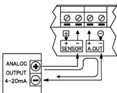
**Salida analógica ACTIVA**. El equipo externo es el que alimenta el bucle de corriente y nuestro equipo va intercalado en ese bucle de corriente.
