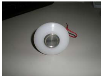
Accesorio para adaptación del pulsador en la piscina
